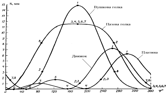
Рис. 3.5 – Синхронна діаграма переміщення робочих органів основов'язальної машини з пазовою голкою
