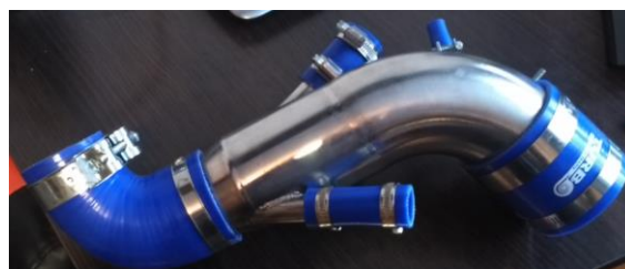
Rys. 2.2.2. Akcesoryjna rura dolotu powietrza do turbosprężarki
