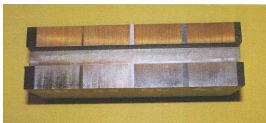
Rys. 7. Próbka do badań z wykonanym rowkiem
