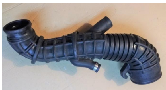
Rys. 2.2.1. Fabryczna rura dolotowa łącząca turbo z filtrem powietrza
