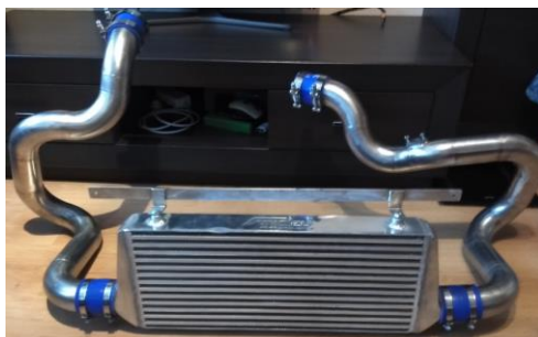
Rys. 2.2.4. Akcesoryjna chłodnica powietrza
