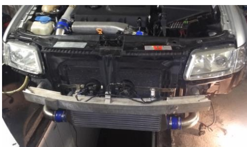
Rys. 2.2.5. Akcesoryjna chłodnica powietrza podczas montażu
