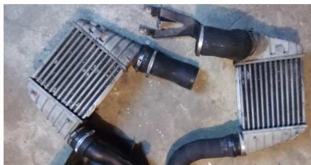
Rys. 2.2.3. Fabryczne chłodnice powietrza
