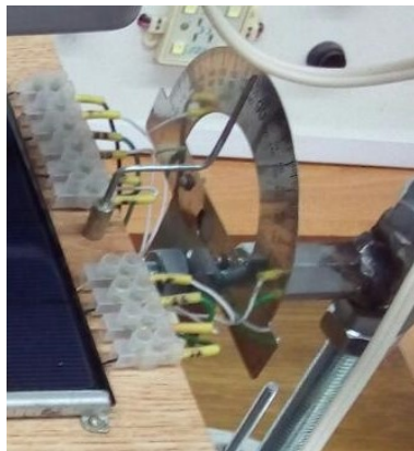
Рис. 1.8 – Кутомір сонячної батареї
