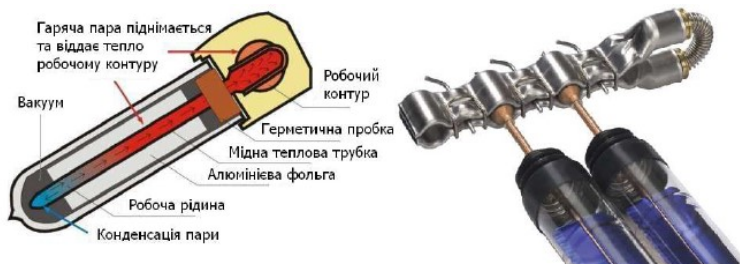
Рис. 2.6 – Принцип роботи вакуумного сонячного колектора
