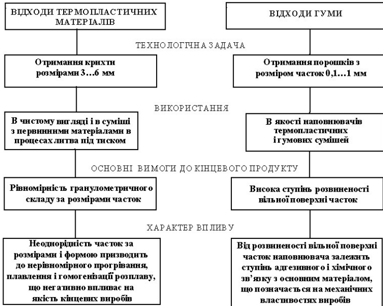
Рис. 8.1 – Технологічні задачі переробки відходів полімерів взуттєвого виробництва
