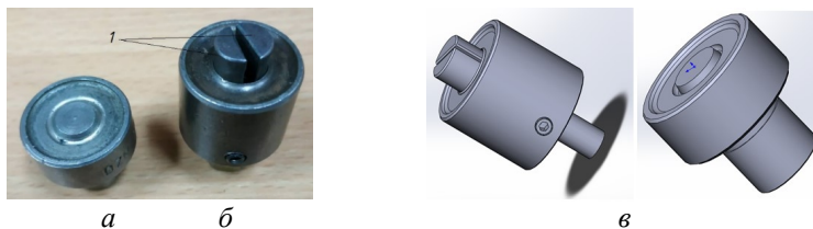
Рис. 5.4 – Загальний вигляд робочих інструментів: а – пуансон; б – матриця; в – модель в програмному середовищі Solid Works ( 1 – тримач)
