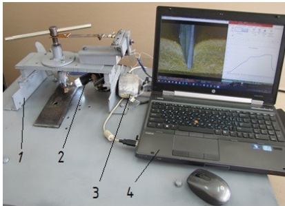
Рис. 6.2 – Експериментальна установка для дослідження операції перфорування взуттєвих матеріалів в умовно статичному режимі
