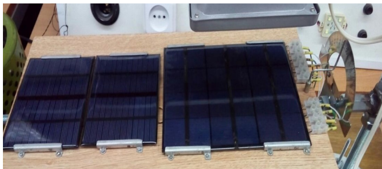
Рис. 1.9 – Конструкція і точки під'єднання панелі сонячної батареї та сонячних елементів
