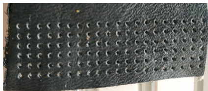
Рис. 6.11 – Фото отриманої деталі верху взуття із перфорацією
