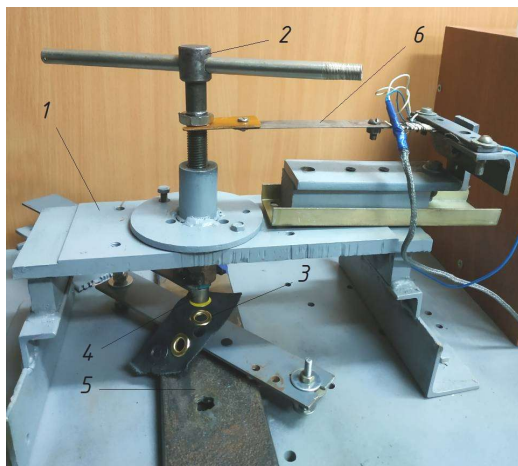
Рис. 5.5 – Пристрій для виконання операції встановлення металевої фурнітури: 1 – станина; 2 – гвинтова пара для навантаження; 3 – матеріал з люверсом; 4 – робочі інструменти (пуансон і матриця); 5 – тензобалка для визначення зусилля встановлення; 6 – тензобалка для визначення величини переміщення пуансона
