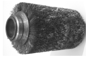
Рис. 7.3 – Голкофреза для остаточного розволокнення структури шкіри
