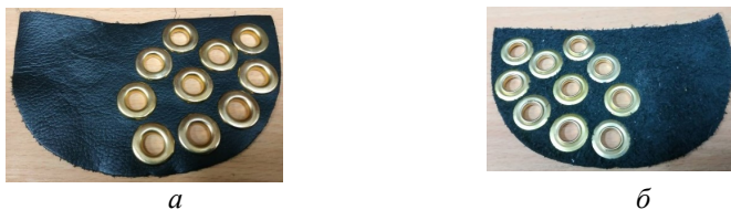
Рис. 5.11 – Зразок натуральної шкіри із встановленими люверсами запропонованим методом (за одну операцію) в динамічному режимі: а – зовнішня сторона; б – внутрішня сторона
